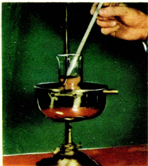
Un fornello ad alcool provvede a riscaldare, con un bagno di acqua come intermediario, le sostanze nel recipiente di vetro, mentre esse stanno reagendo; la temperatura va sorvegliata con un termometro.
